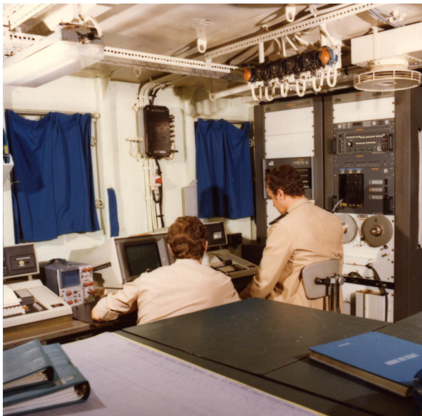
2 - hydrographes-programmeurs à bord du D'Entrecasteaux. À droite, les deux grandes armoires électroniques du SATAD. source : Shom
