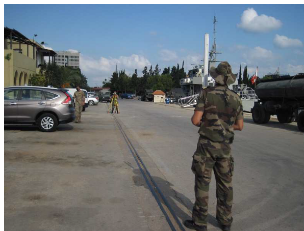
5 - opération de nivellement pour contrôler l'altitude du marégraphe du port
