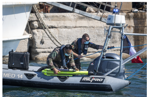
3 - déploiement du sondeur latéral par l'équipe SDHM ©Terence Wallet/Marine Nationale/Défense
