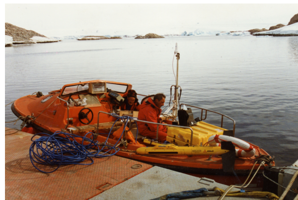
2 - à bord de leur vedette, les hydrographes du Shom se préparent à sonder le fond. Au premier plan, le sondeur latéral (avec une bouée de sauvetage sur un de ses ailerons) source : Shom
