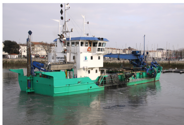
7 - à défaut du Concorde , voici une photographie d'une drague aspiratrice à benne et à clapets : le Fort-Boyard Jpbazard Jean-Pierre Bazard, CC BY-SA 3.0 < https://creativecommons.org/licenses/by-sa/3.0/ >, via Wikimedia Commons
