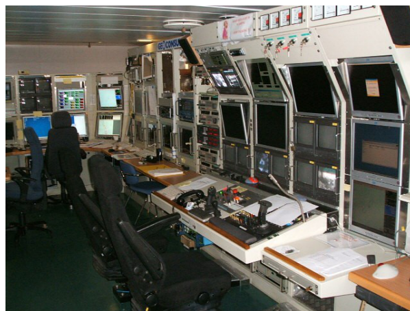
3 - vue partielle d'un PC opérations (au fond le système d'acquisition, poste de l'hydrographe de quart) Photothèque Amhydro - X
