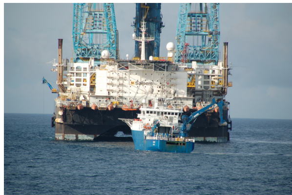
1 - construction et pose de pipe-line au printemps 2006 par la barge SAIPEM 7000. Le Geobay, de taille respectable (longueur: 90m, largeur 15m, hauteur hors antennes 16m) paraît bien petit à côté Photothèque Amhydro - X
