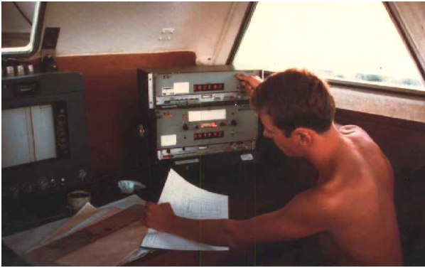
5 - le secrétaire de vedette avec à gauche le sondeur et à droite un récepteur Toran Photothèque Amhydro - X
