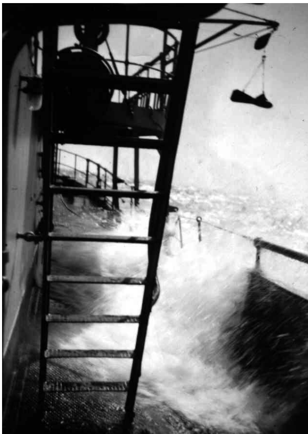
2 - 1951 - la Sentinele en mer, en moyenne sonde devant Casablanca, les passavants arosés - le plomb poisson en haut à droite sert à l'étalonnage du sondeur photothèque Amhydro - J.-S. Jupas
