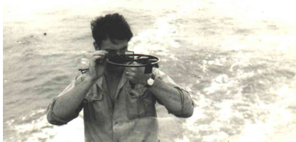
1 - un observateur sur vedette avec son cercle hydrographique - pendant deux siècles, à partir de 1791, cette image était typique des hydrographes français ou d'une nation ayant adopté le cercle hydrographique (les anglo-saxons utilisaient de leur côté le sextant tenu horizontalement) photothèque Amhydro - J.S. Jupas
