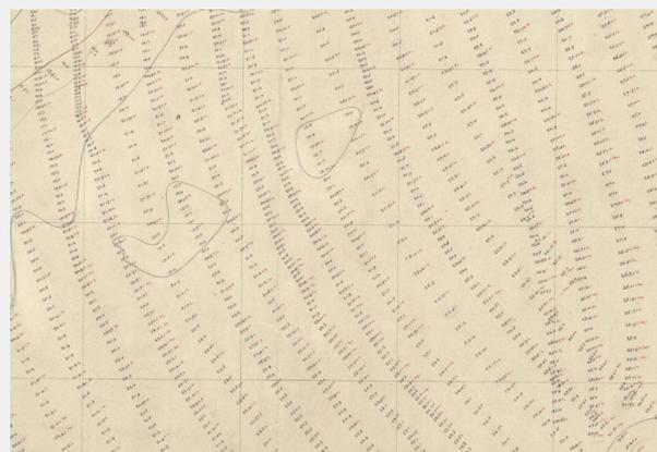
3 - détail d'une minute levée dans le golfe de Saint-Tropez en 1897. Les lignes de sonde correspondent à des segments (arcs de cercle) et la couverture de la zone est systématique - minute hydrographique ancienne 017\_2\_19\_Cr\_1897, téléchargeable sur le site data.shom.fr
