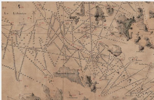
1 - détail d'une des dernières minutes du pilote français, levée en 1838 dans le secteur de l'Aber-Wrac'h. Les routes suivies correspondent à des alignements et la couverture de la zone n'est pas systématique - minute hydrographique ancienne 009\_1\_05\_18\_Cr\_1938, téléchargeable sur le site data.shom.fr
